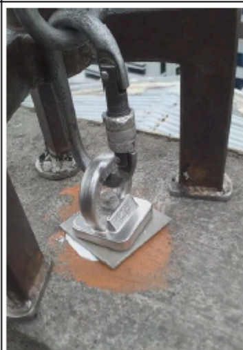
Teste de tração nº 38 - Após 1 minuto tracionado
